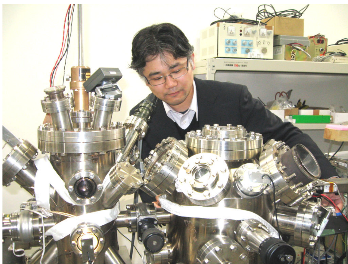
写真：走査トンネル顕微鏡を調整している様子。
